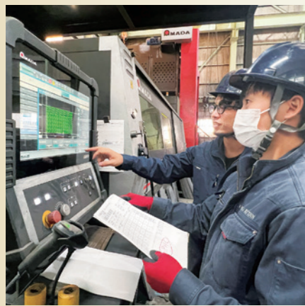
鉄板を切断する機械：ファイバーレーザーマシン
