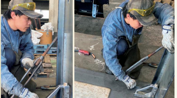
機器を乗せる台盤の図面に合わせて製缶する作業
