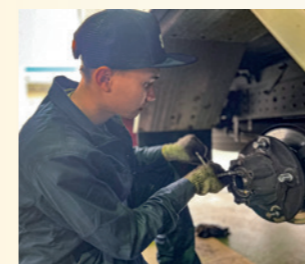
車両後輪の点検整備
